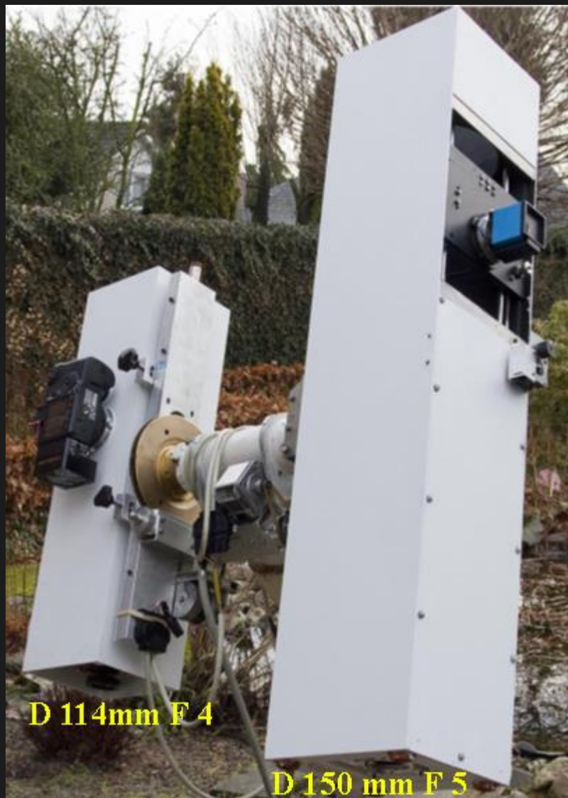
Eigenbouw newton D 114mm F 4 . Scherpstelling door primaire spiegel te verstellen.
