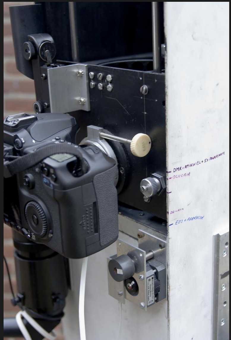
Eigenbouw newton D 150mm F 5 met eerder genoemd focussysteem.
